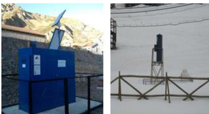
Figura 3. 2 Fotografías de dos equipos generadores terrestres de yoduro de plata. A la derecha estación Chapa Verde y a la izquierda la estación Bocatoma Pangal, ambas ubicadas en la cuenca río Cachapoal, Chile.
